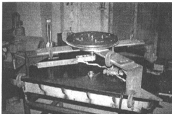
图 3 机械定位装置和测量臂在平台上校正, 平台上的电插头是低真空测磁用
